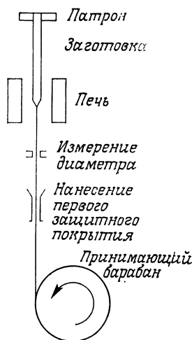
Рис. 10.7. Станок для вытягивания волокна.
